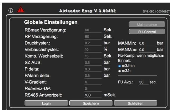
bestimmt die Zeit in Sekunden, die die Steuerung wartet, wenn die Parameter **Regelbereich Max (RBmax)** bzw. **Regel-puffer (RP)** bei FU-Kompressoren erreicht sind, bevor die zu- und Abschaltung von Kompressoren erfolgt.
